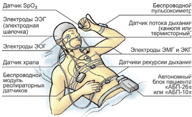
Рис. 7. Конфигурация полисомнографической системы.
