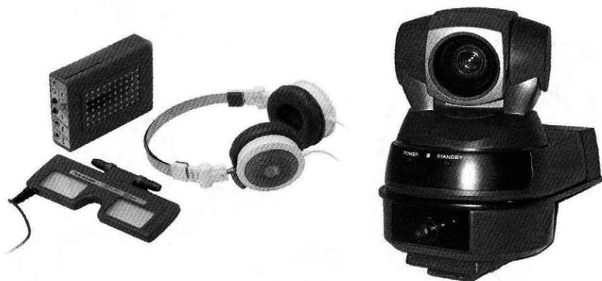
Рис. П.4. Беспроводной блок стимуляции с принадлежностями и видеорегистратор
