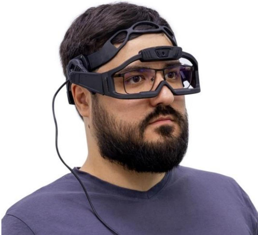
**Фото слева:** Конструкция сенсорных очков для айтрекера реализована таким образом, что они могут беспрепятственно использоваться для людей, носящих свои коррекционные очки с диоптриями.
