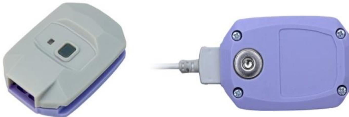
Позволяет подключать различные датчики, как одиночные, так и комбинированные, для регистрации большого количества различных физиологических сигналов, в частности, кожной проводимости (КПр), фотоплетизмограммы (ФПГ), электрокардиограммы (ЭКГ), температуры, электромиограммы (ЭМГ), биполярной электроэнцефалограммы (ЭЭГ), двигательной активности и пр. Ниже приведены некоторые примеры таких датчиков
