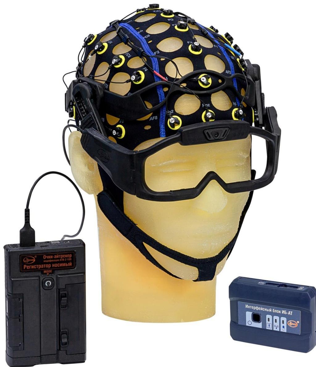
Пример конфигурации съема глазо-двигательной активности и физиологических данных с большим набором регистрируемых сигналов. Вид человека со всем установленным на него оборудованием для регистрации физиологических сигналов (ЭЭГ, ЭКГ, ФПГ, КПр, рекурсия дыхания, двигательная активность), глазо-двигательной активности, контента с «камеры сцены» и звукового потока с микрофона приведен на рисунке справа.
