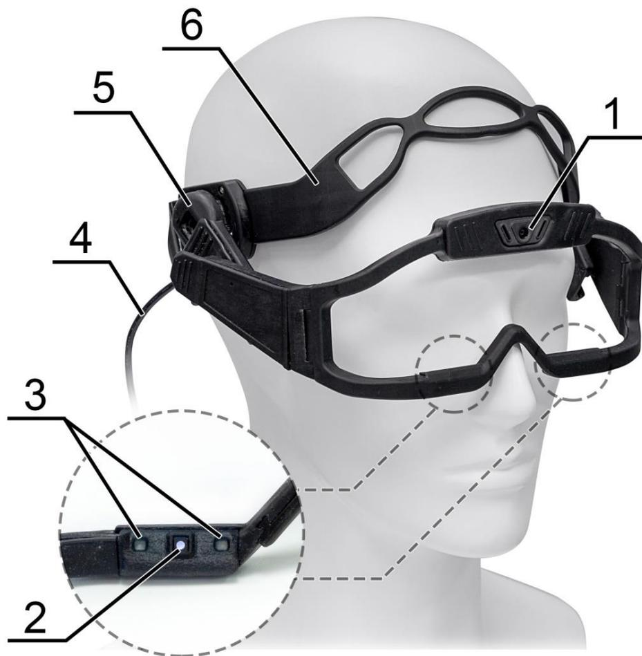
Носимые очки-айтрекер – это устройство, состоящее из сенсорных очков и носимого регистратора, закрепляемого на поясе, а также прикладного программного обеспечения для персонального компьютера, с помощью которого выполняется анализ глазодвигательной активности.
