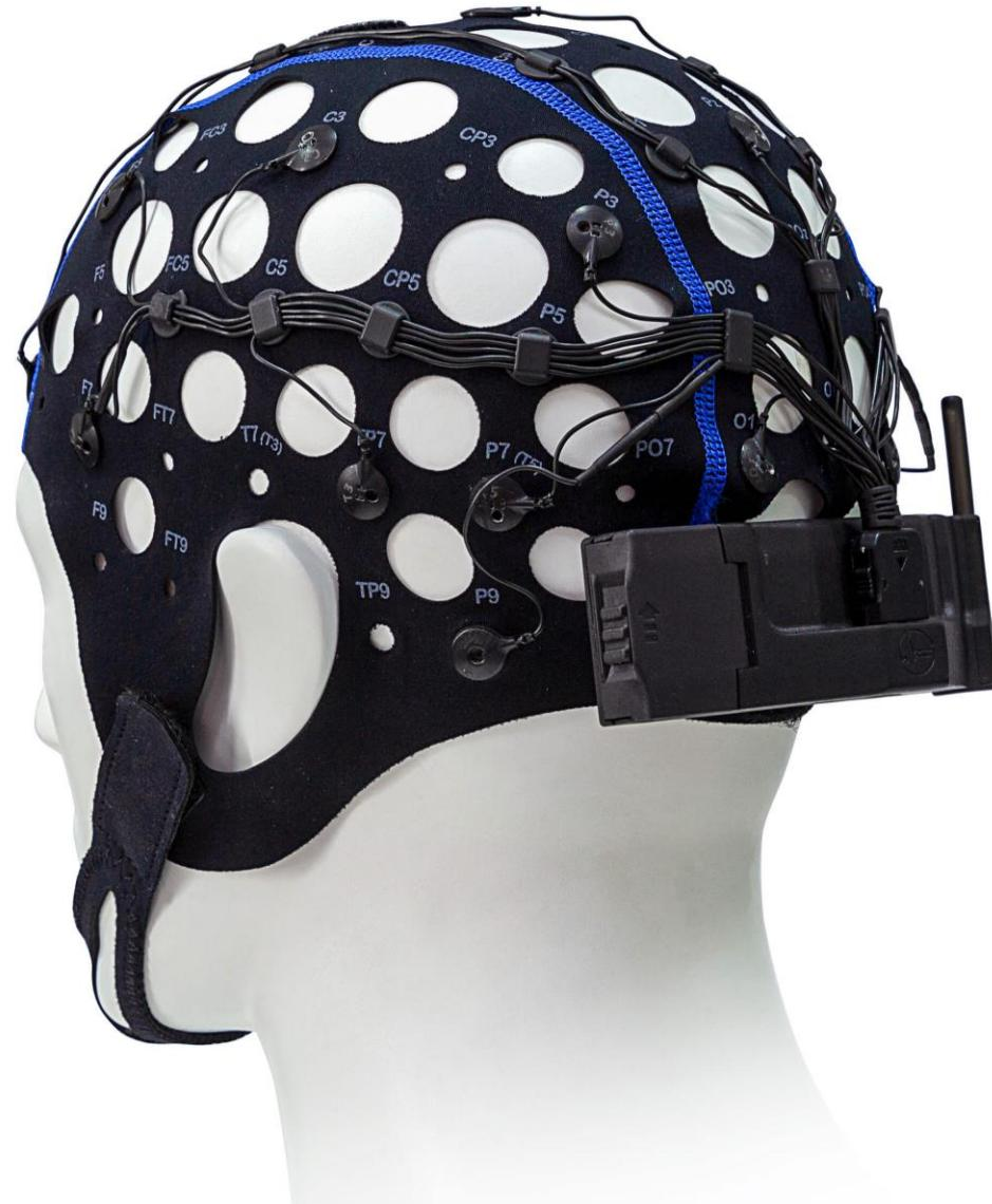
Рисунок 10 – Пример ТЭШ-гарнитуры для АБП-24-АТ с хлорсеребряными электродами
