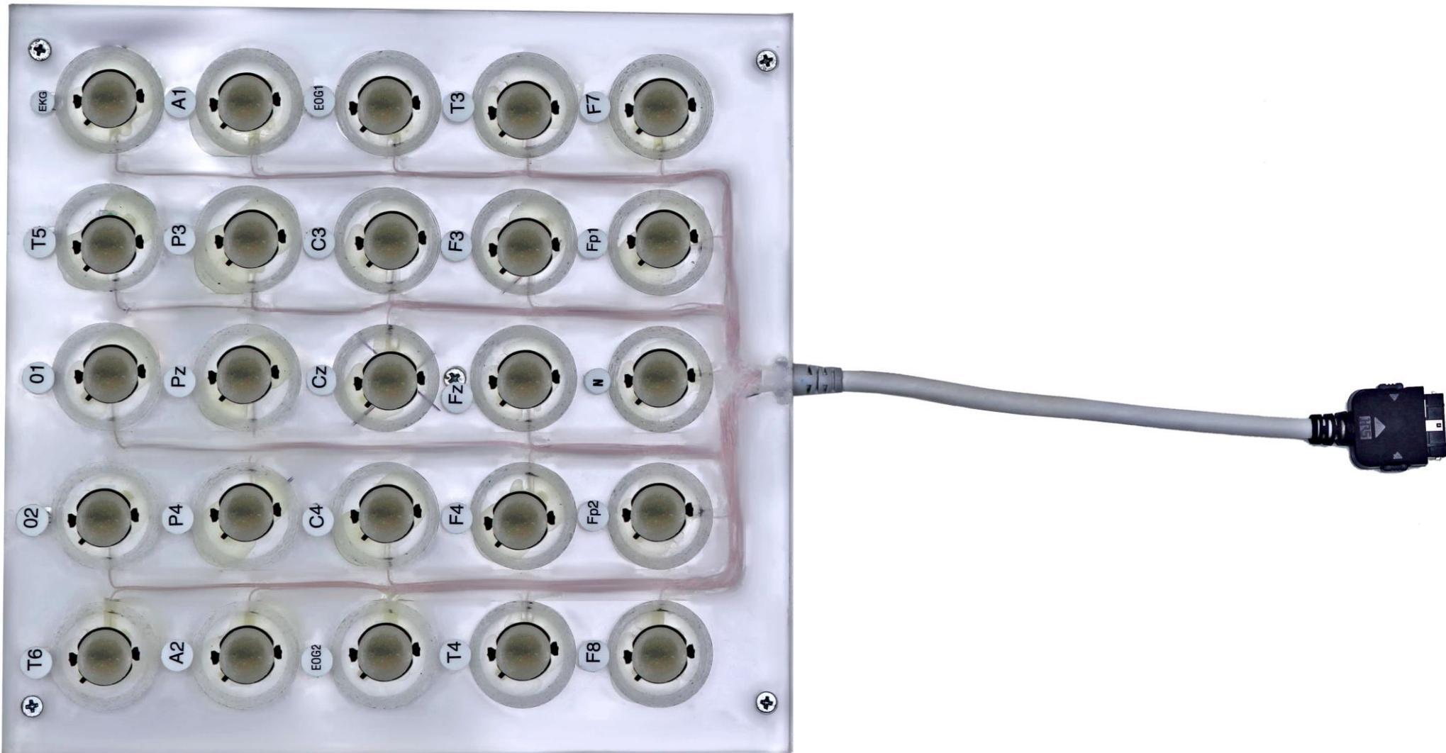
Рисунок 7 – Проверочная панель для кнопочных электродов
