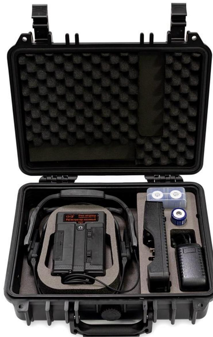
**Фото справа:** Кейс для транспортировки комплекта поставки очков-айтрекера АТВ-2, включающего в себя все необходимые компоненты (сенсорные очки, регистратор данных, зарядное устройство, целеуказатель калибровки).
